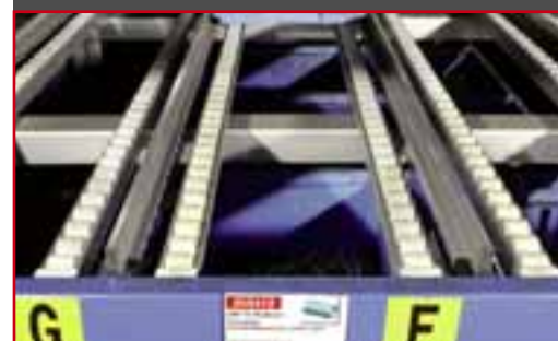
Individuelle Einstellung der Röllchen und Trennleisten
