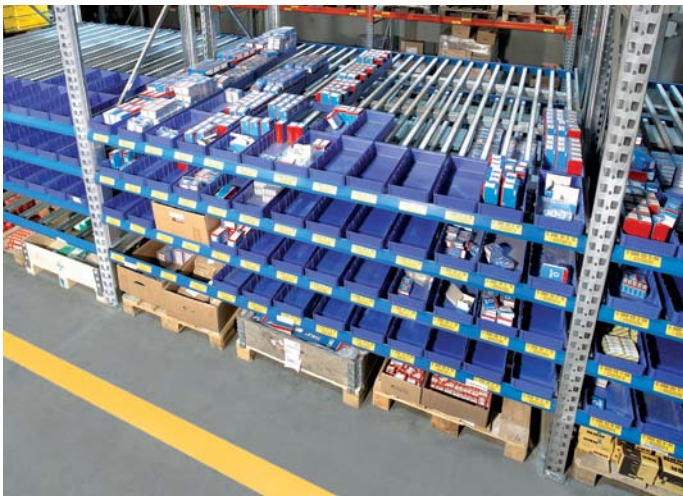
Die Durchlaufebenen sind individuell auf die verschiedensten Behältergrößen einstellbar
