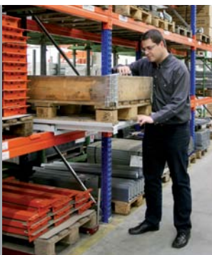
Palettenauszüge erlauben müheloses Herausziehen von Paletten aus dem Regal oder auf dem Boden
