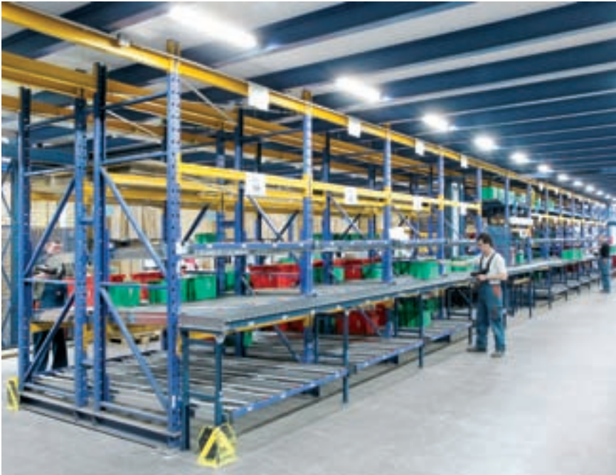
META Kommissionierregal mit einer zusätzlichen, querlaufenden Transport-Rollenbahn zur Beschickung der Regale.
