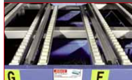
Individuelle Einstellung der Röllchen und Trennleisten
