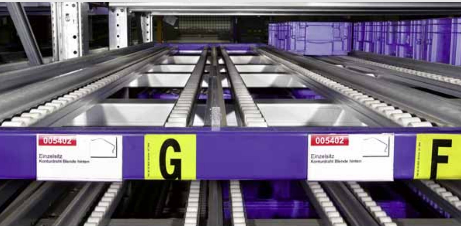
Kanalansicht mit Vorderleiste und Regalplatzetikettierung
