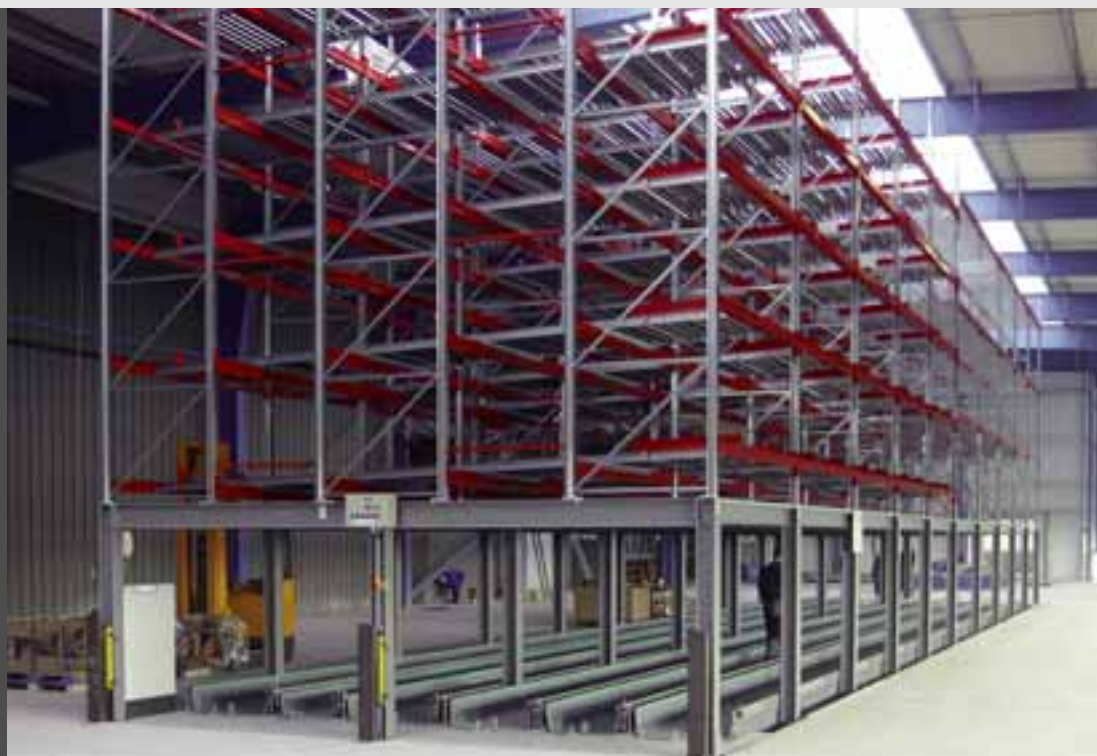
Fahrwege im META MULTILINE® S Durchlaufregal
