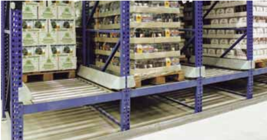
Einsetztrichter an der Einlaufseite
