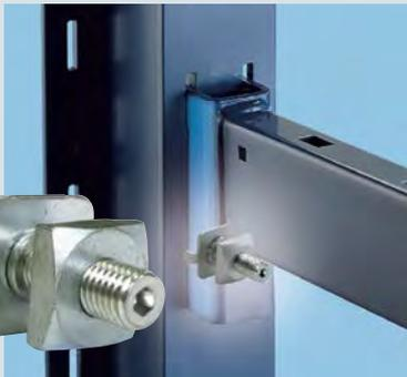
Durch Anziehen der Stellschraube wird eine gleichmäßige Vorneigung erreicht. Rundmaterial rollt so automatisch Richtung Ständer. Gleichzeitig wird eine feste Verbindung zwischen Kragarm und Ständerprofil hergestellt.
