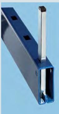
Die Abrolldorne werden in die Kragarme eingesteckt. Sie können von unten nicht unbeabsichtigt herausgestoßen werden. Die Kragarme sind im Abstand von 100 mm gelocht.
