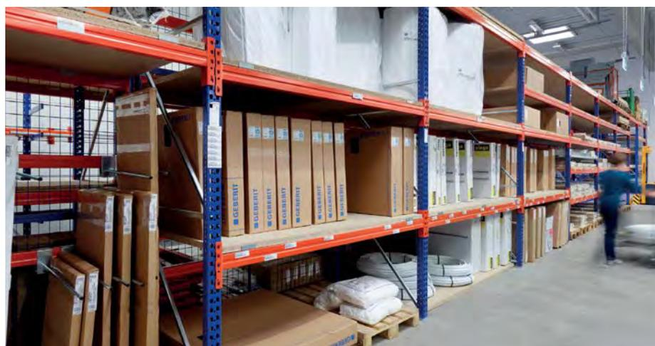
**⚠ Bitte beachten Sie: Bei der Steigerung der Tragkraft durch Tiefenauflagen darf die zulässige Holmtragkraft nicht überschritten werden!**
