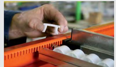
Röllchen aus hochwertigem Kunststoff mit stabilen Stahllachsen
